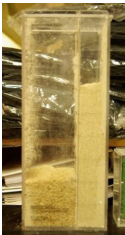
Рис. 10.1. Спеціальне сито для визначення співвідношення помолу комбікорму (BYGHOLM – SIEVE)
