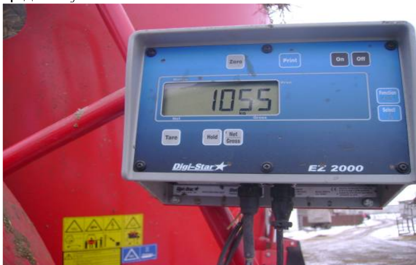
Рис. 1. Цифрове табло системи зважування кормозмішувача «TRIOLET- SOLOMIKS»
