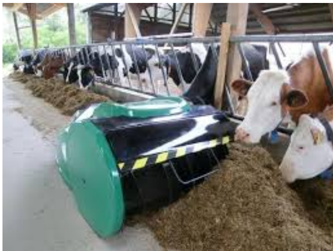
Рис. 4.28. Робот-підгортач Butler Gold
