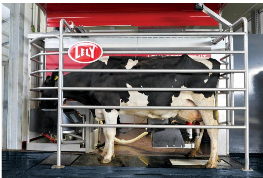
Рис. 4.30. Роботизована доїльна система Lely Astronaut A4
