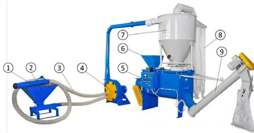
Рисунок 6 – Малогабаритна комбікормова установка МКУ-0,7: 1 – ежектор; 2 – бункер завантаження затарених компонентів, які потребують подрібнення; 3 – гнучкий шланг; 4 – молоткова дробарка; 5 – блок керування роботою; 6 – горловина завантаження преміксів; 7 – ваговий бункер-циклон; 8 – фільтри-пилословлювачі; 9 – відвантажувальний шнековий транспортер
