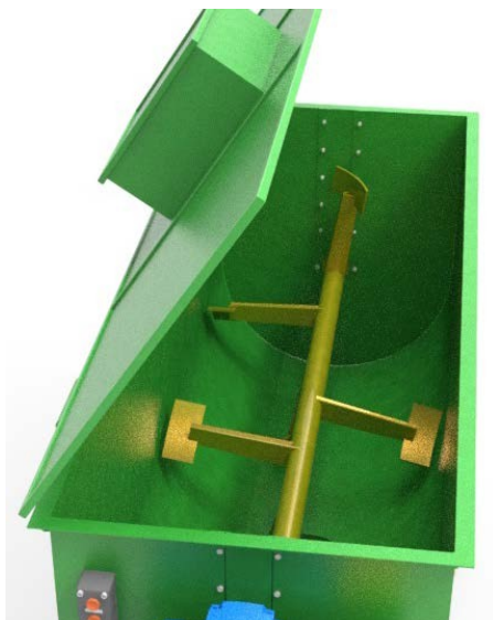
Рисунок 7. – Робочі органи змішувачів: а - горизонтальний стрічковий; б – горизонтальний лопатевий двоваловий; в – горизонтальний лопатевий одноваловий; г – вертикальний лопатевий
