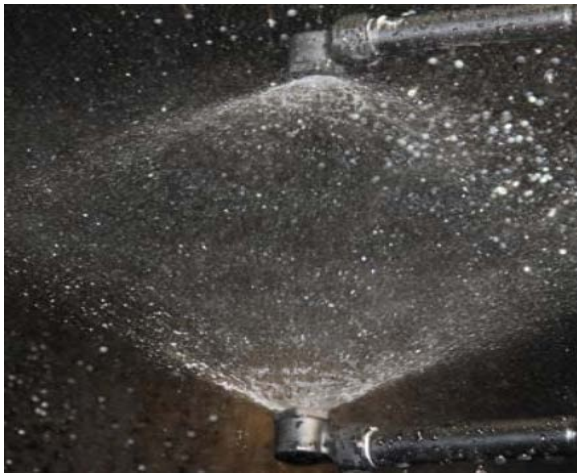
Рисунок 15- Схема робочого процесу установки HelixX (а) та блок форсунок для розпилення води (б) та їх робота (в):
