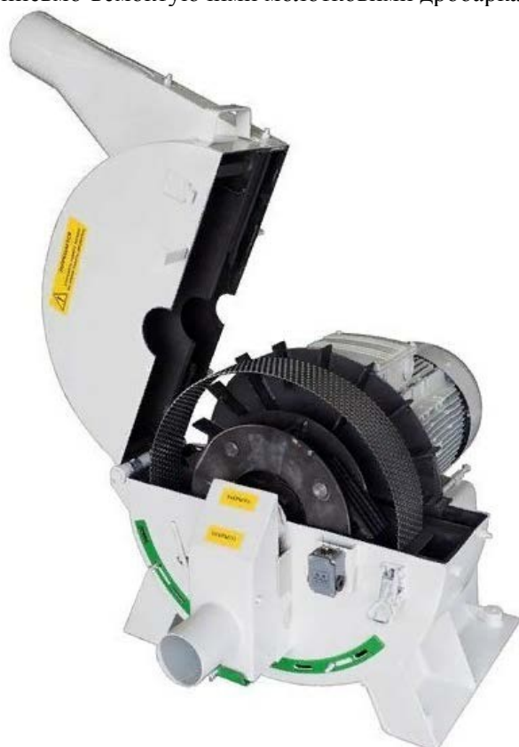
Рисунок 7.12 – Молоткова дробарка для зерна з пневмозавантаженням: 1 – станина; 2 – всмоктуючий патрубок; 3 – сепаратор дробарки; 4 – передня кришка; 5 – ротор; 6 – молоток; 7 – жалюзі; 8 – решето; 9 – вивантажний патрубок; 10 – електродвигун
