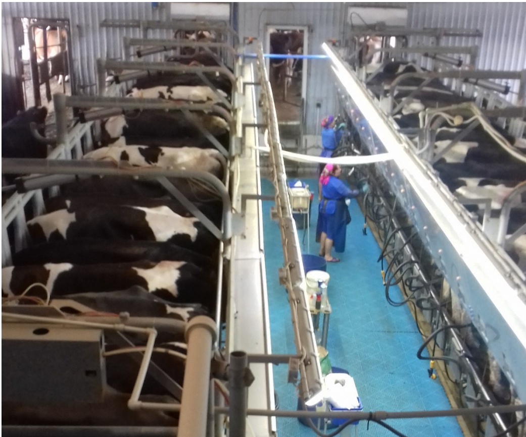
Рис. 2. Доїльна зала паралель 2×10 (Де Лаваль)
