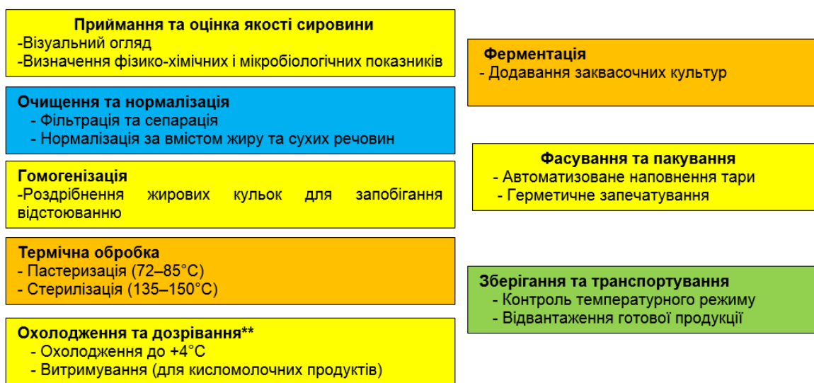
Рис.1. Технологічна схема переробки молочної сировини
